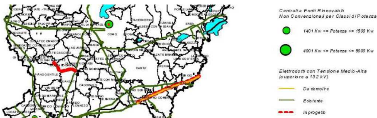
Centrali ed elettrodotti (Fonti: Edison Rete, Enel Distribuzione, TERNA)
